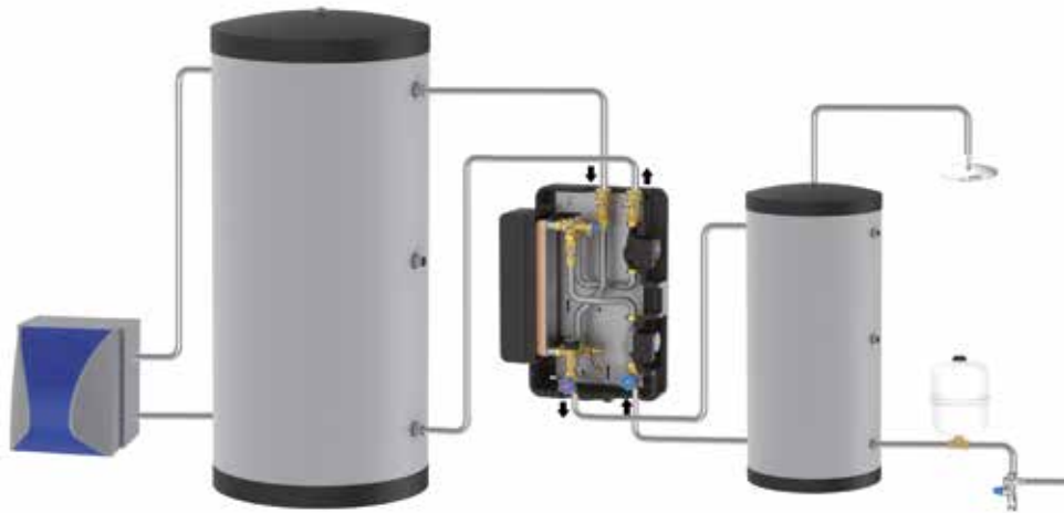
Montagebeispiel Speicher-Umladestation Maxi als Ladespeichermodul mit Pufferspeicher
